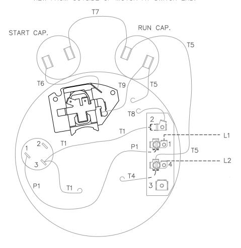
P1, T1, T4 TO GO TO BACK SIDE OF TERMINAL BOARD
