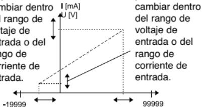
El voltaje de entrada mínimo o la corriente de entrada mínima se pueden cambiar dentro del rango de voltaje de entrada o del rango de corriente de entrada.
