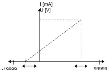
El valor que se muestra se puede ajustar libremente en el valor de entrada dentro del rango de pantalla.
